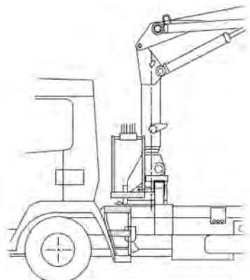
**Figura 6:** Piattaforma di comando con gradini di accesso
